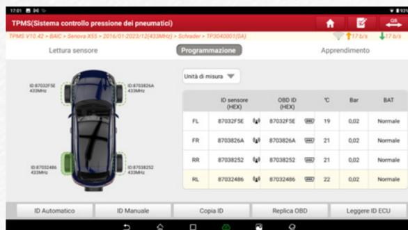
Il menù di apprendimento permette di seguire tutti gli step per la procedura corretta di inizializzazione dei sensori TPMS, garantendo una perfetta riuscita della sostituzione e riparazione in tutte le situazioni previste dal costruttore. Con la funzione "acquisizione ID da OBD" è possibile creare un nuovo sensore TPMS direttamente recuperando le informazioni della ECU del veicolo.
